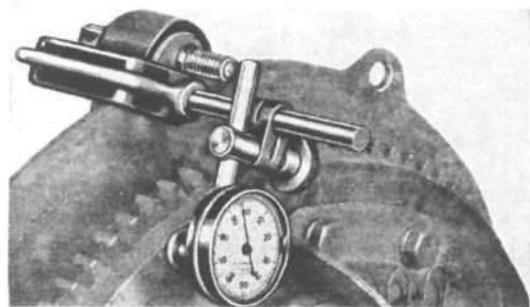
FIG. 125—FLYWHEEL RUNOUT GAUGE
