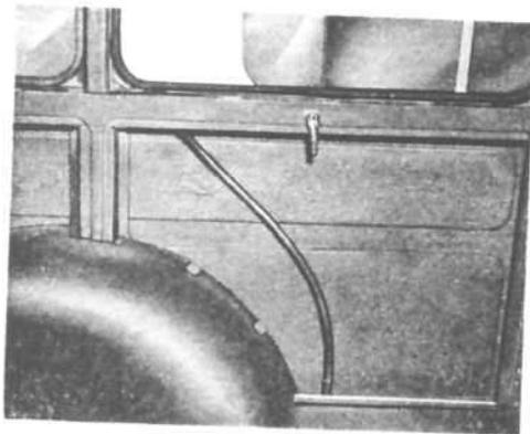
FIG. 310—SIDE WINDOW DRAIN
