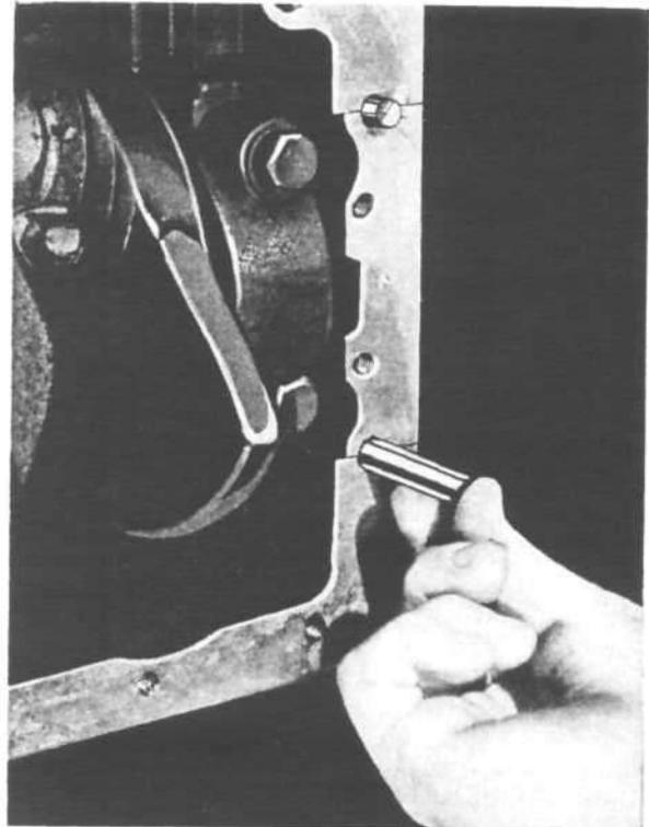
FIG. 109—REAR BEARING CAP PACKING
