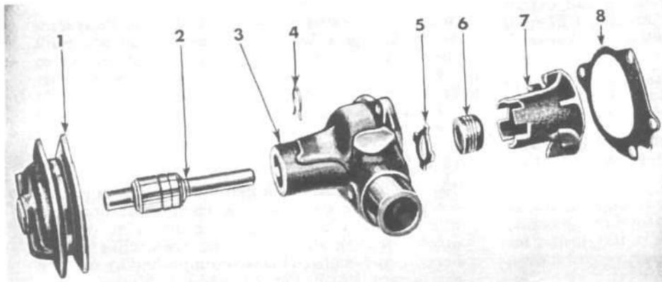
FIG. 148—WATER PUMP MODEL F4-134
