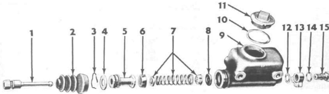
FIG. 284—MASTER BRAKE CYLINDER
