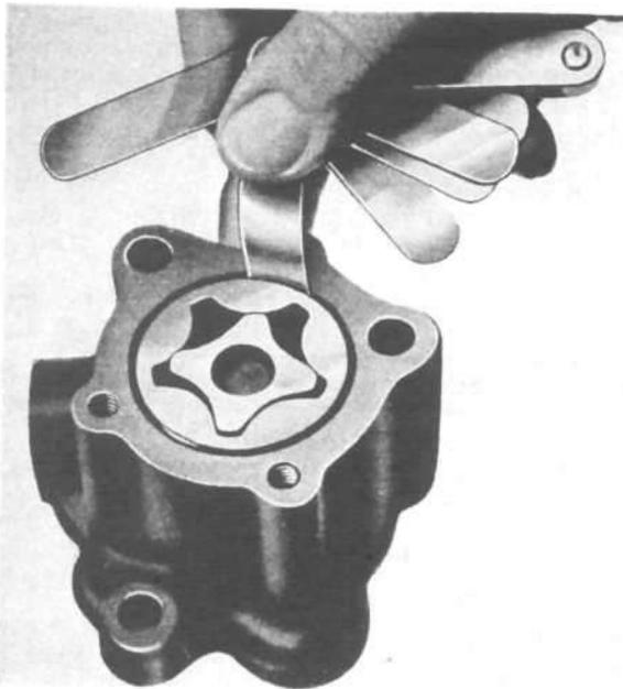
FIG. 122—CHECKING OUTER ROTOR TO OIL PUMP BODY
