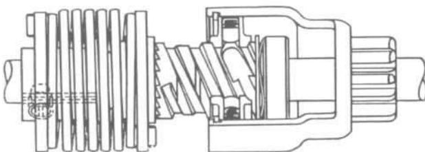
FIG. 170—BENDIX FOLO-THRU DRIVE
