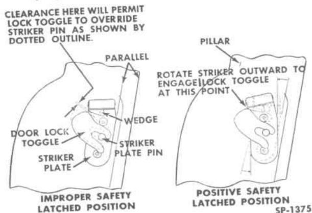
FIG. 304—LOCK TOGGLE AND STRIKER PLATE POSITION
