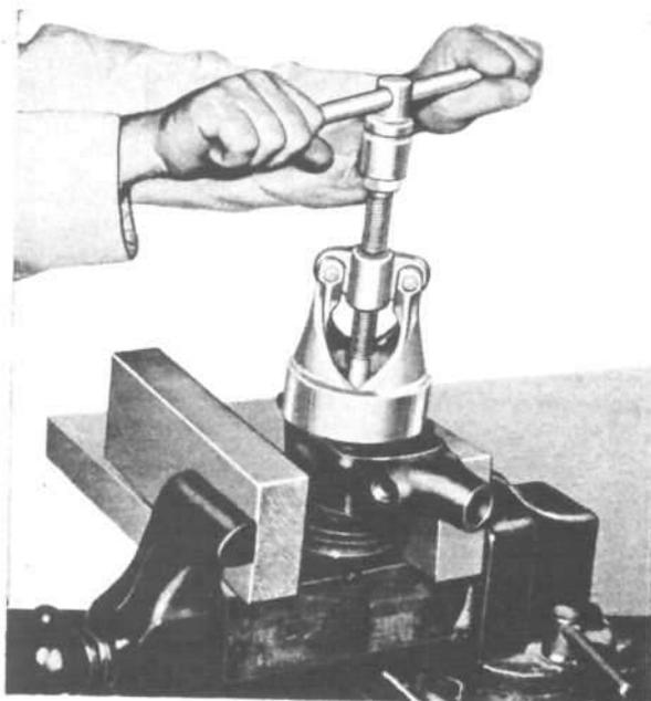
FIG. 150—WATER PUMP IMPELLER PULLER
