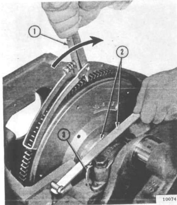
FIG. 27—REMOVING REAR FILLER BLOCK GUARD
