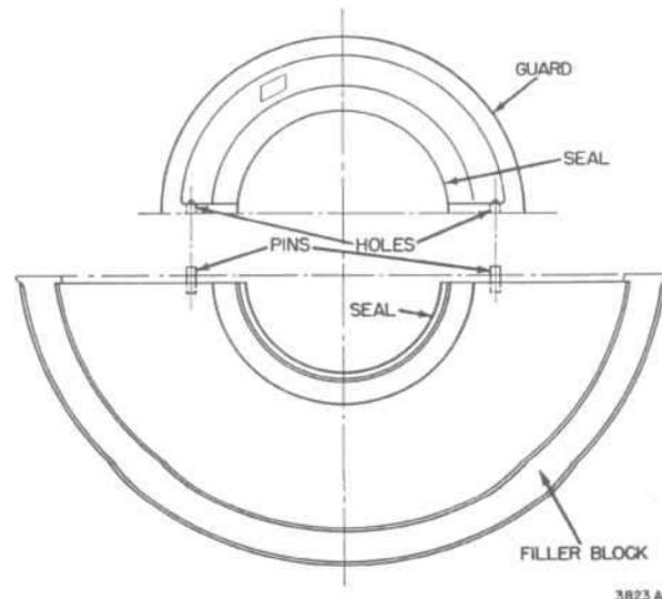
FIG. 70—CRANKSHAFT REAR FILLER BLOCK DOWEL PINS
