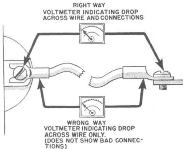
FIG. 17—VOLTAGE DROP TEST
