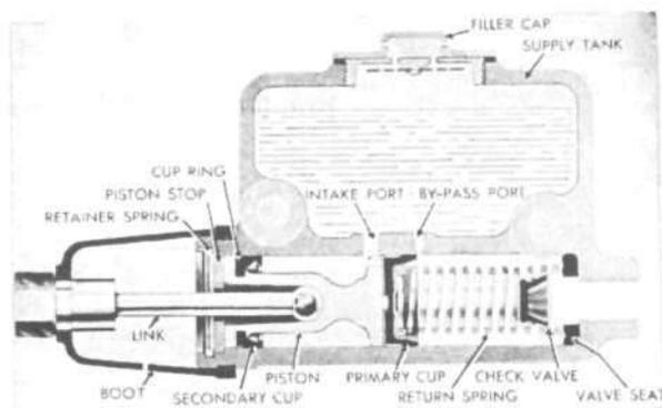
FIG. 285—BRAKE MASTER CYLINDER
