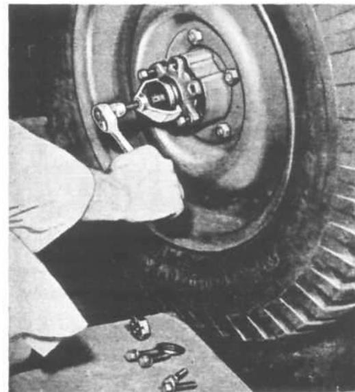
FIG. 228—AXLE SHAFT DRIVE FLANGE PULLER
