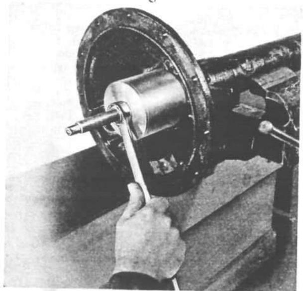
FIG. 271—DIFFERENTIAL BEARING CUP PULLER
