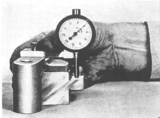
FIG. 257—PINION MASTER GAUGE
