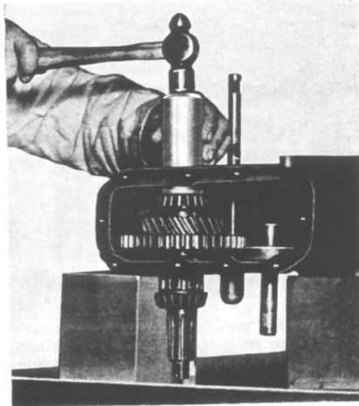
FIG. 213—BEARING CONE DRIVER
