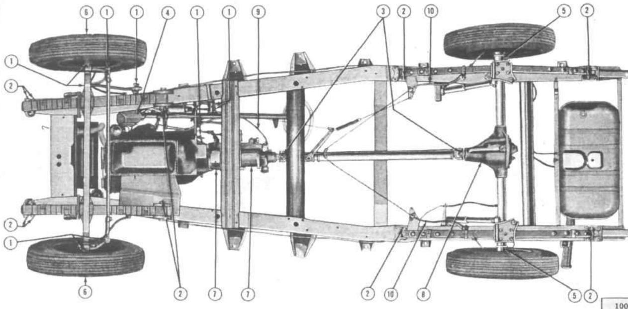
FIG. 8—LUBRICATION CHART — MODEL F4-134 4x2
