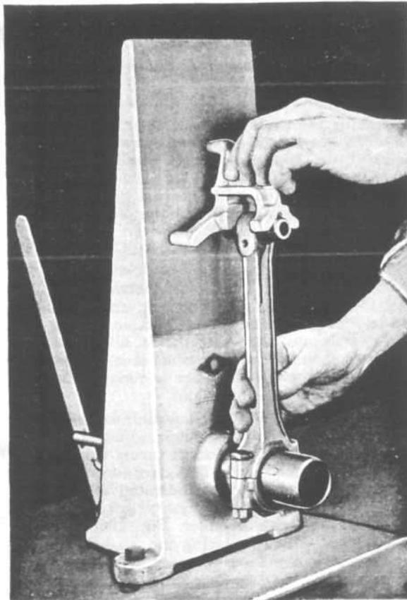
FIG. 111—CONNECTING ROD ALIGNER
