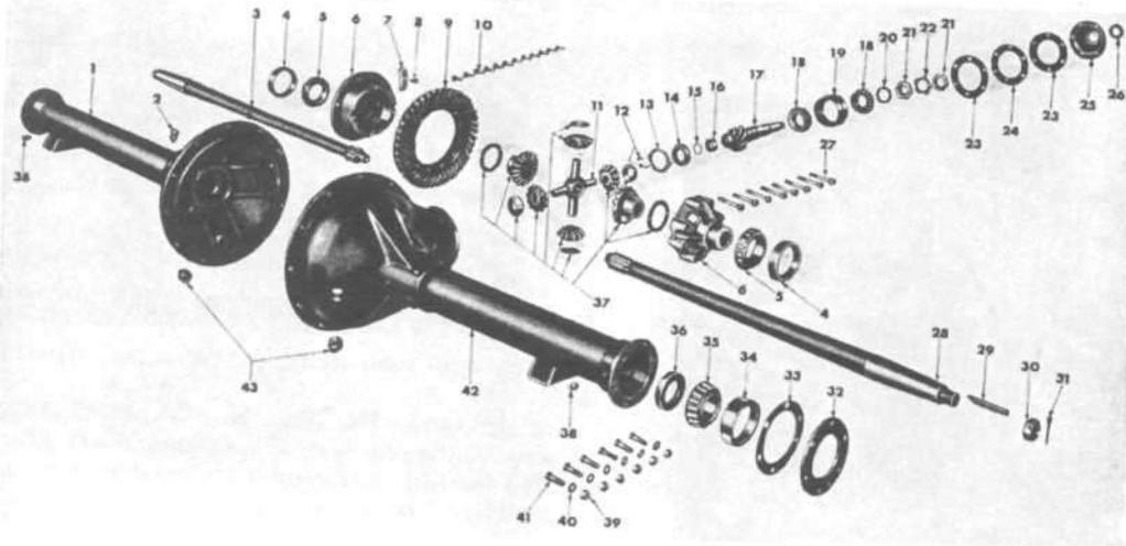
FIG. 270—SPIRAL BEVEL REAR AXLE
