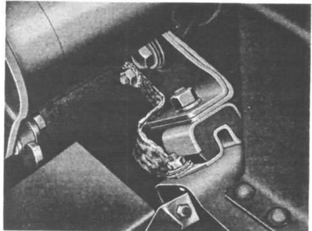
FIG. 10—ENGINE GROUND STRAP
