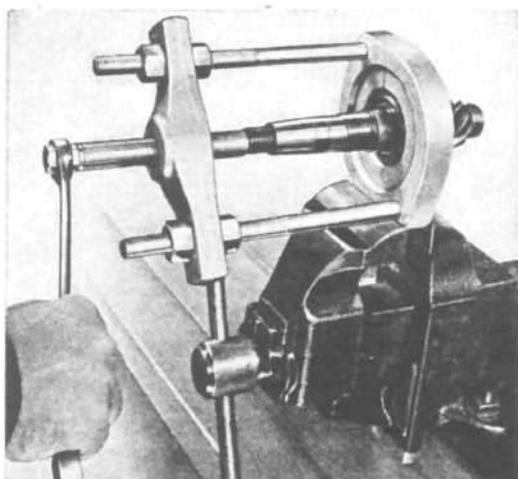
FIG. 251—BEARING PULLER
