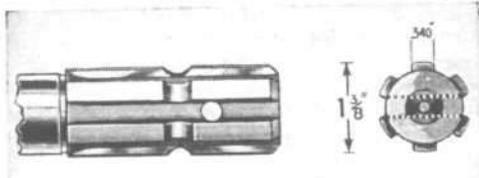
FIG. 314—POWER TAKE-OFF SPLINED SHAFT
