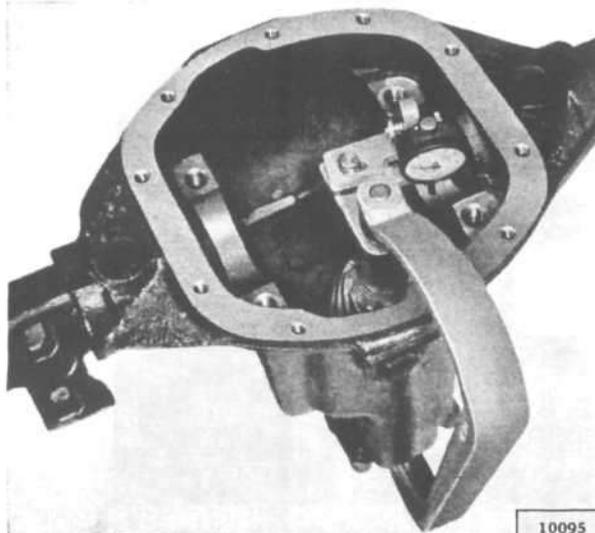
FIG. 256—PINION SETTING GAUGE
