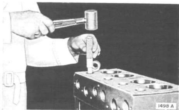
FIG. 101—VALVE GUIDE DRIVER
