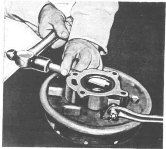
FIG. 217—SPEEDOMETER PINION BUSHING DRIVER
