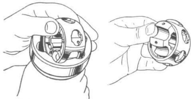
FIG. 231—REMOVING RZEPPA JOINT CAGE
