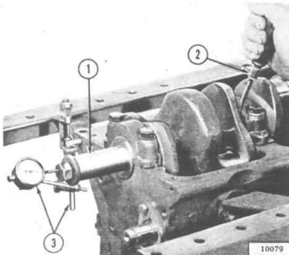
FIG. 52—CHECKING CRANKSHAFT END-PLAY
