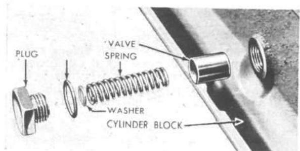
FIG. 31—OIL PRESSURE RELIEF VALVE
