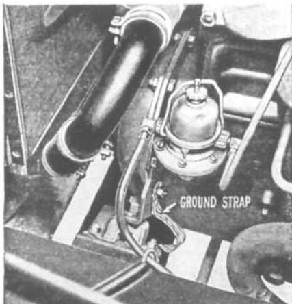
FIG. 126—ENGINE GROUND STRAP
