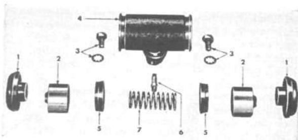
FIG. 287—WHEEL BRAKE CYLINDER
