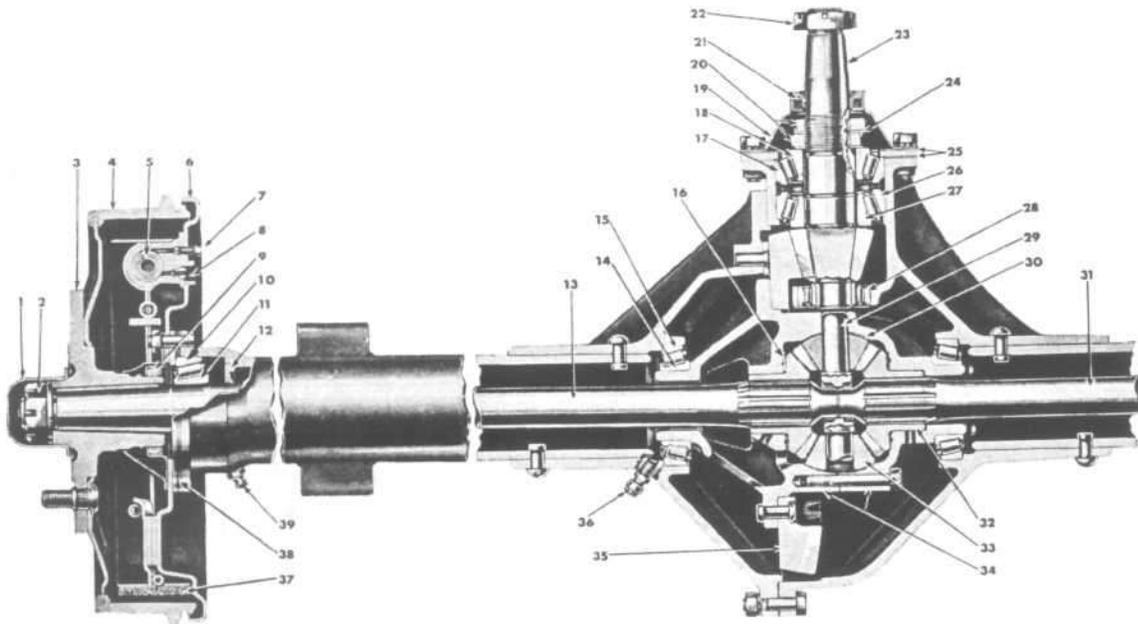
FIG. 269—SPIRAL BEVEL REAR AXLE
