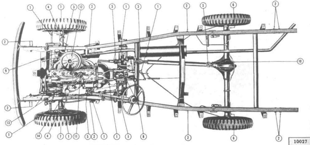
FIG. 4—LUBRICATION CHART — MODEL L6-226 4x4
