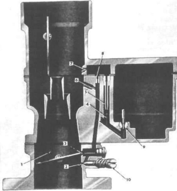
FIG. 129—THE LOW SPEED CIRCUIT
