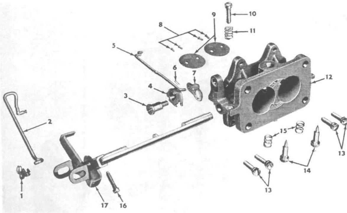
FIG. 137—2204S BODY FLANGE AND ATTACHING PARTS
