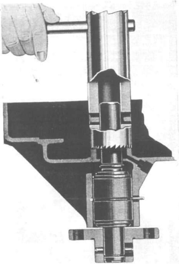
FIG. 152—WATER PUMP HOUSING SEAT REFAKER
