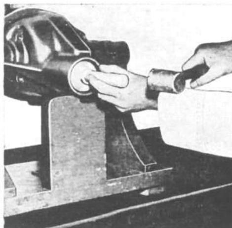
FIG. 254—PINION SHAFT FRONT BEARING CUP DRIVER
