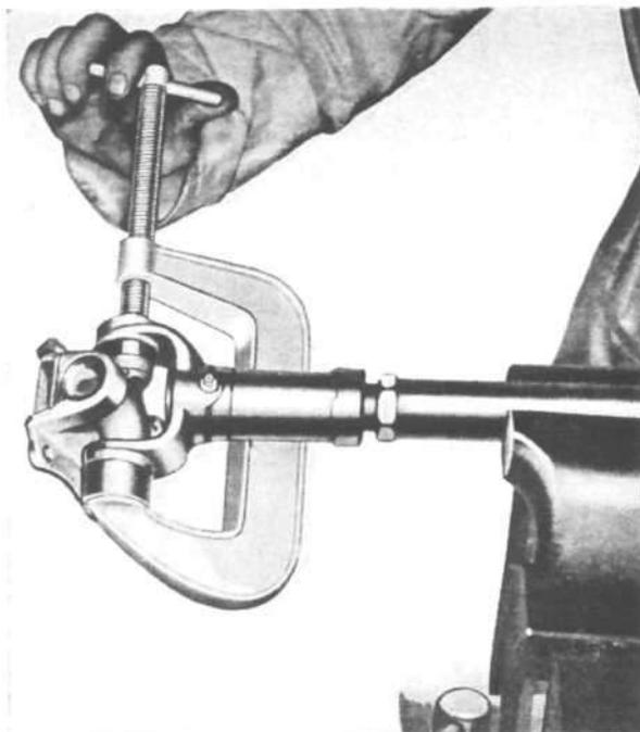
FIG. 225—UNIVERSAL JOINT BEARING CLAMP
