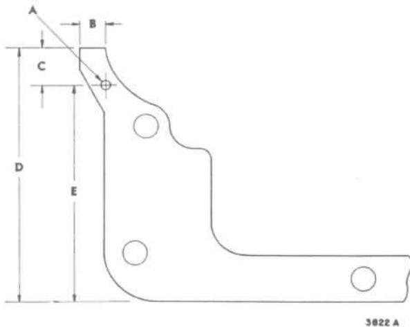
FIG. 91—OIL PAN GASKET HOLE LOCATION
