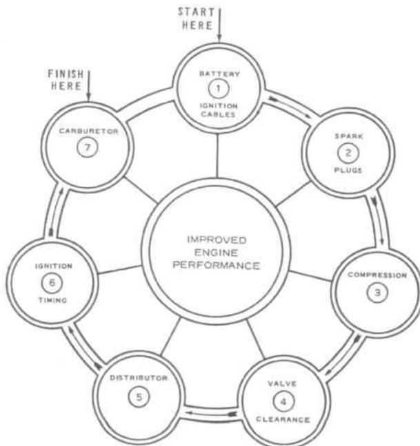
FIG. 9—ENGINE TUNE-UP CYCLE
