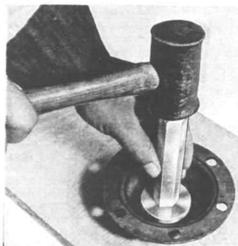
FIG. 277—PINION OIL SEAL INSTALLER
