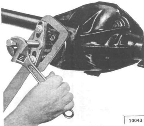
FIG. 248—END YOKE PULLER
