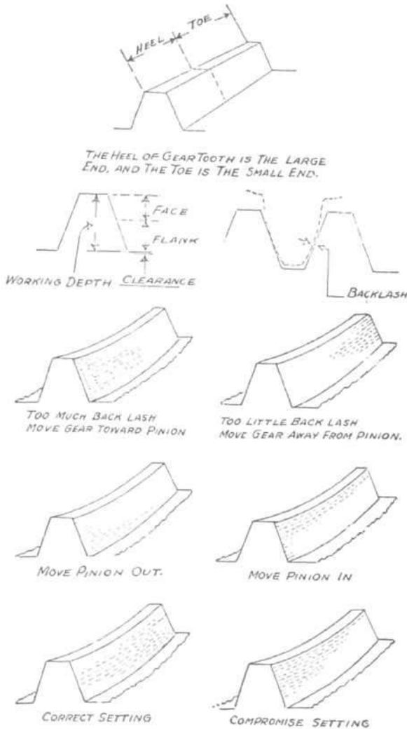
FIG. 265—GEAR TOOTH CONTACT
