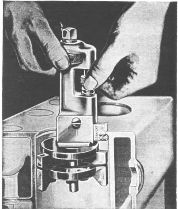
FIG. 114—CYLINDER RIDGE REAMER
