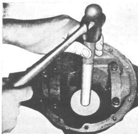
FIG. 253—PINION SHAFT REAR BEARING CUP DRIVER
