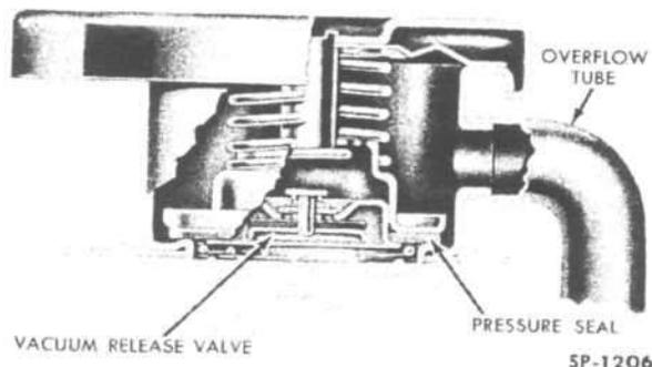
FIG. 147—RADIATOR FILLER CAP
