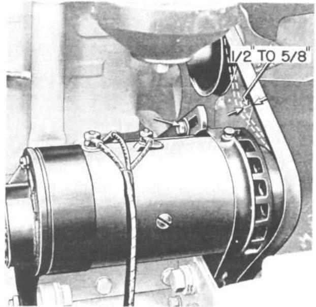
FIG. 154—GENERATOR BRACE
