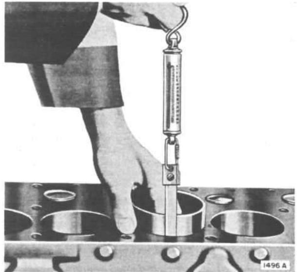
FIG. 113—PISTON FITTING
