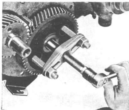
FIG. 106—TIMING GEAR PULLER
