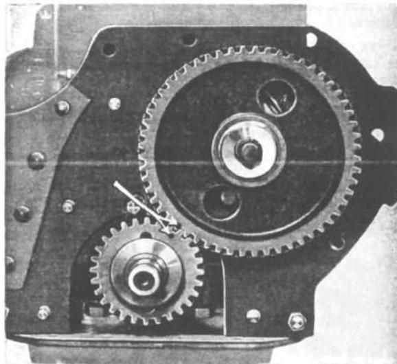
FIG. 108—TIMING GEARS
