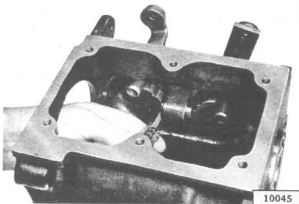
FIG. 197—INTERLOCK SLEEVE CLEARANCE
