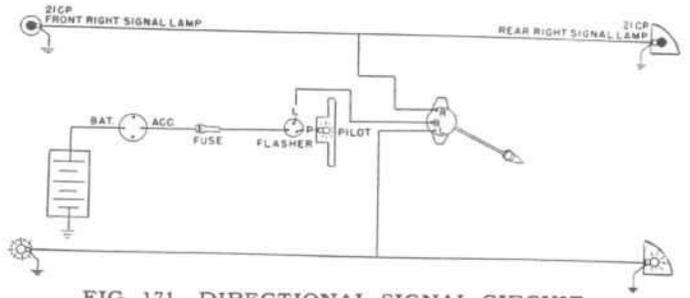
FIG. 171—DIRECTIONAL SIGNAL CIRCUIT
