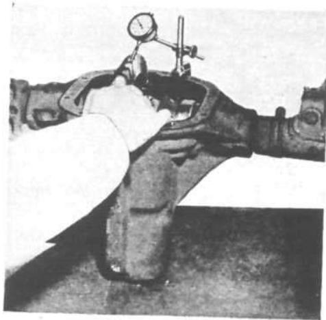
FIG. 266—BACK LASH CHECKING GAUGE
