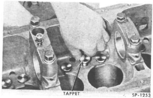
FIG. 30—REMOVING VALVE TAPPET FROM CYLINDER BLOCK
