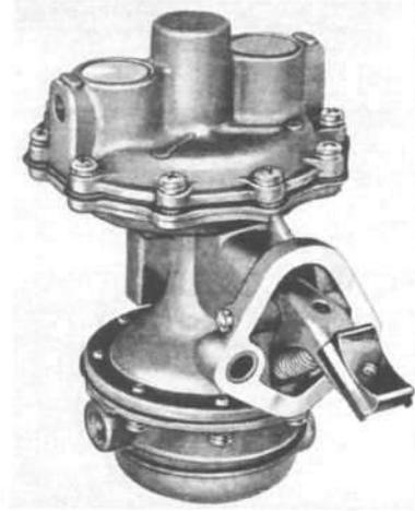
FIG. 141—FUEL AND VACUUM PUMP —
