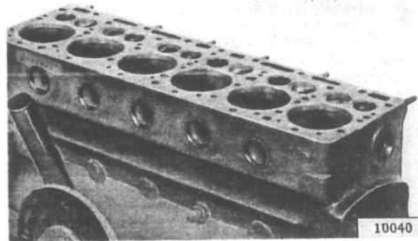
FIG. 80—CORE HOLE EXPANSION PLUGS
