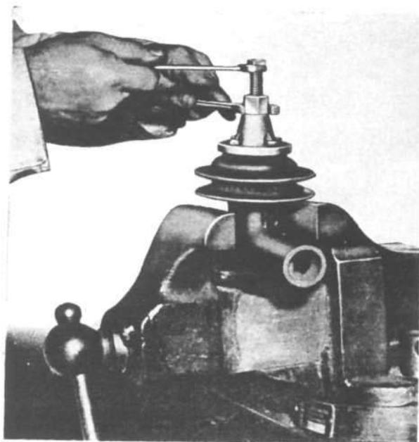
FIG. 151—WATER PUMP FAN HUB PULLER
