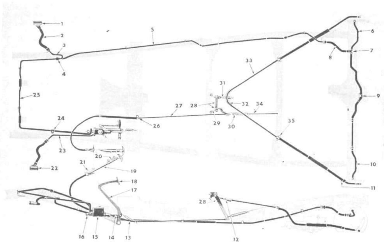
FIG. 283—BRAKE SYSTEM—MODEL F4-134 4WD
