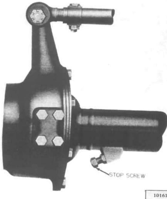
FIG. 239—TURNING ANGLE STOP SCREW
