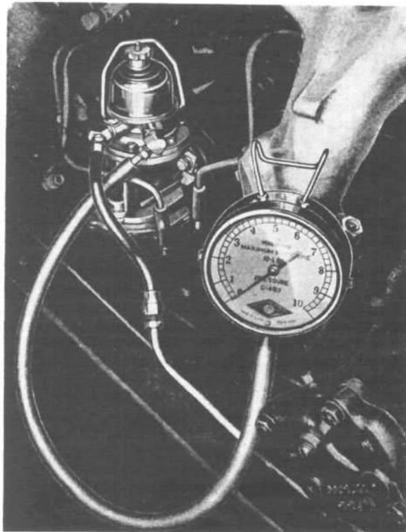
FIG. 15—FUEL PUMP PRESSURE
