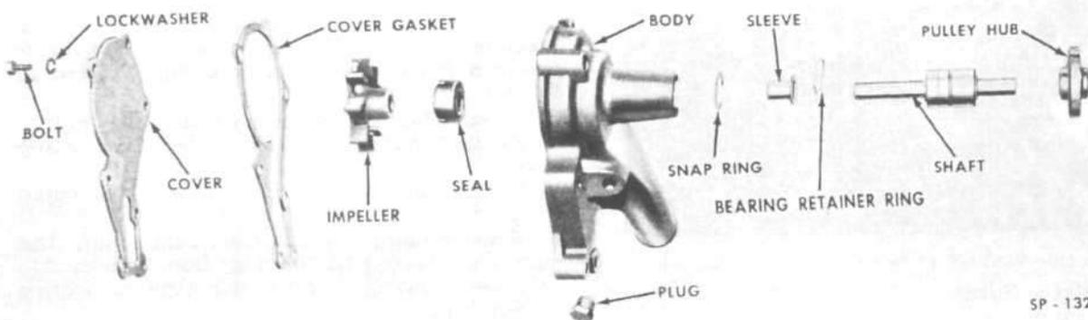
FIG. 153—WATER PUMP—MODEL L6-226
