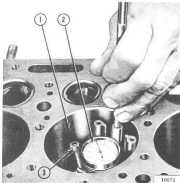
FIG. 34—CHECKING CYLINDER BORE
