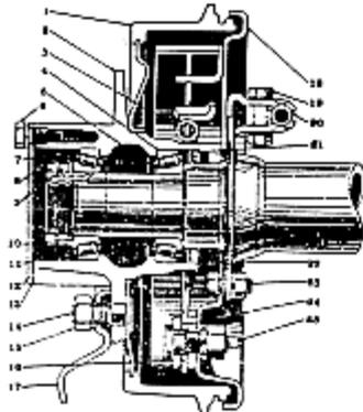
FIG. 13—WHEEL BEARINGS
