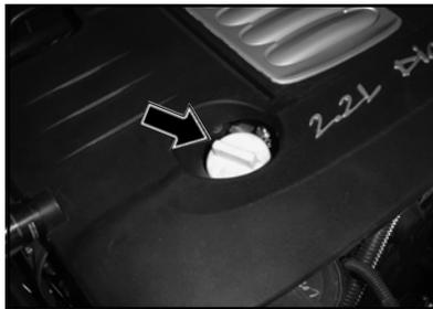
**ENGINE OIL FILLING CAP (DICOR)**
