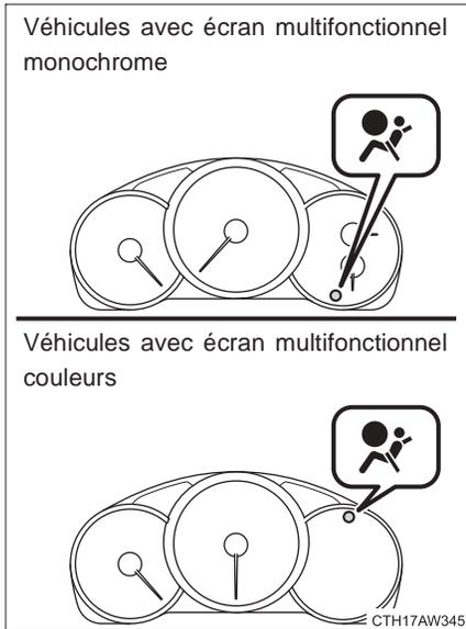
Un système de diagnostic contrôle continuellement la fonctionnalité du système d'airbag SRS (y-compris les prétensionneurs des ceintures de sécurité avants) lors de la conduite du véhicule. Le témoin lumineux du système d'airbags SRS montrera l'opération normale en s'allumant pendant environ 6 secondes quand le contacteur de démarrage est mis en position "ON".
