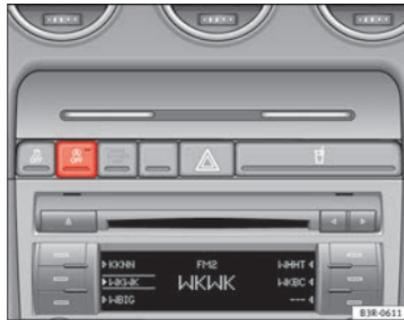
Fig. 137 The Start-Stop function button.
