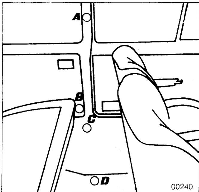
Los cinturones de seguridad para los pasajeros de las butacas anteriores se entregan de dotación. El coche está predispuesto para la colocación de cinturones de seguridad para los pasajeros del asiento posterior; los agujeros de fijación van disimulados por tapones de plástico.
