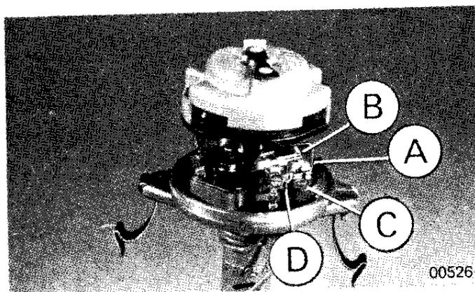
La distancia entre los contactos **B** del ruptor (platinos) debe de ser de  $0,37 \div 0,43$  mm; para un eventual reglaje aflojar el tornillo **C** y separando la chapa portacontactos con un destornillador sobre la hendidura **D**; terminado el reglaje, apretar a fondo el tornillo **C**.
