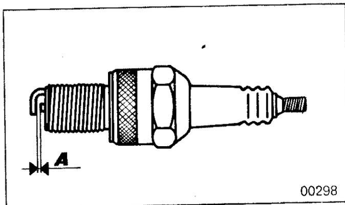
Al mismo tiempo verificar con una galga la distancia de los electrodos **A**, debe ser de  $0,6 \div 0,7$  mm. En caso contrario, acercar el electrodo exterior hacia el interior; no se debe nunca actuar sobre el electrodo central para evitar posibles roturas de la porcelana aislante.
