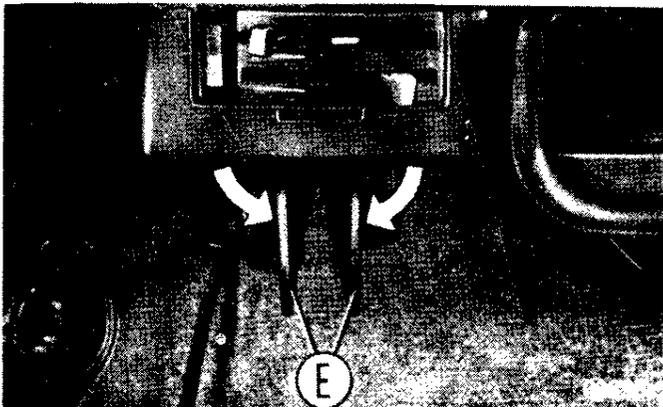
El aire caliente es introducido en el interior del coche a través de los difusores orientables **D** y de las ventanillas **E**.
