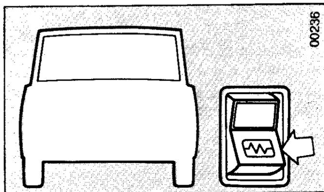
Para un rápido desempañamiento o descarchamiento del cristal posterior del coche, **las versiones Confort, Confort Lujo y CLX** llevan incorporadas unas resistencias eléctricas (luneta térmica). Para su funcionamiento oprimir el interruptor que lleva incorporado un indicador óptico (resistencia conectada).
