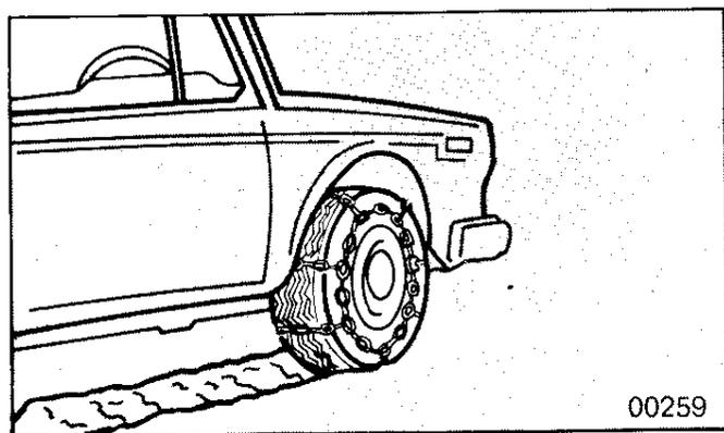
En el período invernal, para evitar el peligro de deslizamiento sobre la nieve o sobre hielo, es necesario hacer uso de cadenas a montar en las ruedas motrices (anteriores), o bien disponer de neumáticos claveteados que en este caso se deben montar en todas las ruedas, teniendo en cuenta las normas en vigor en el país en que se circula.
