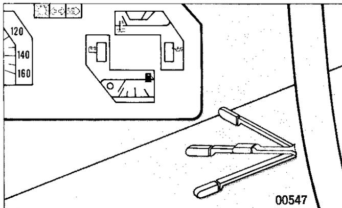
Con la llave del conmutador de encendido en las posiciones MAR o EST, haciendo oscilar la palanca hacia el volante se obtienen ráfagas de las luces de cruce aunque todas las luces estén apagadas.
