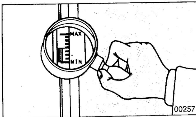
Periódicamente o bien antes de emprender un largo viaje controlar el nivel del aceite del motor, del líquido de frenos, del líquido de refrigeración del motor y el nivel del electrolito de la batería. Por lo que respecta al aceite del motor, si no es del tipo multigrado, es necesario asegurarse que corresponda a la graduación exigida por la temperatura ambiente (ver tabla de ABASTECIMIENTOS, pág. 82).
