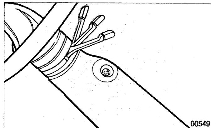
Para la puesta en funcionamiento del lavacristales eléctrico desplazar la palanca hacia el volante (**versiones Comfort, Comfort Lujo y CLX**); para el funcionamiento del lavacristales manual oprimir el pulsador de goma.
