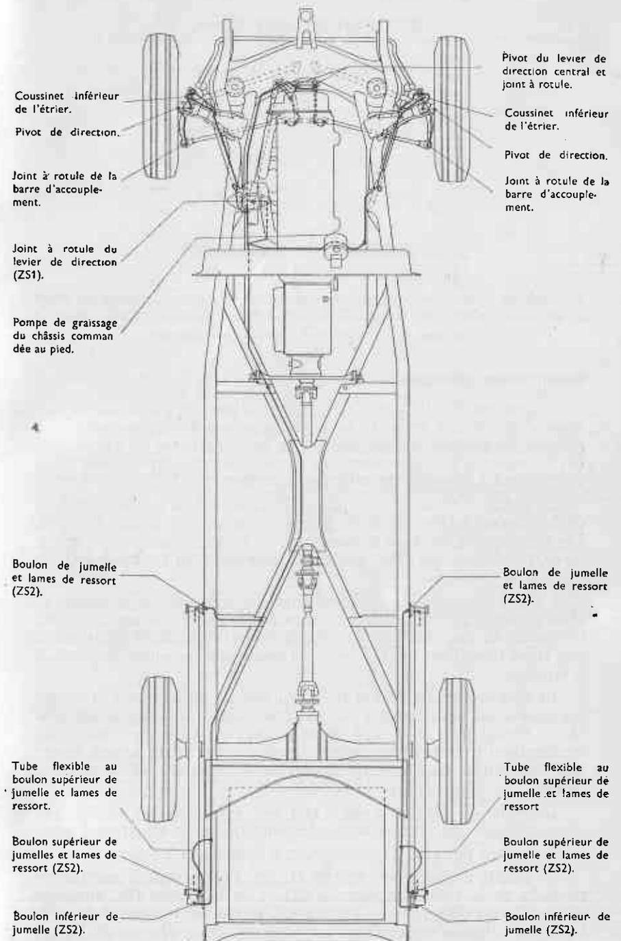
Fig. 5.—SCHEMA DU SYSTEME DE GRAISSAGE DU CHÂSSIS.
