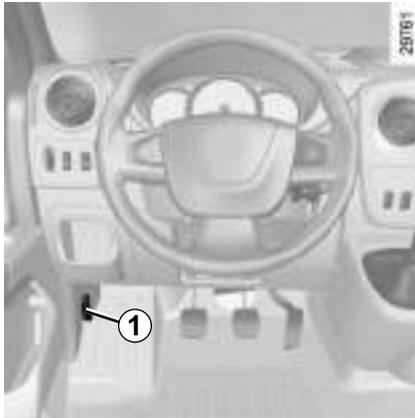
Zum Öffnen am Hebel **1** ziehen.
