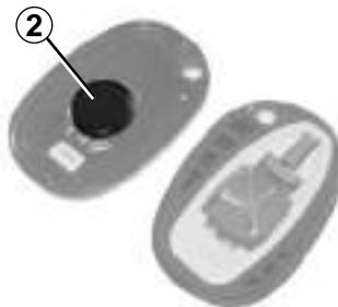
Die Batterie **2** austauschen; auf korrekte Polarität (im Gehäusedeckel eingepreßt) achten!
