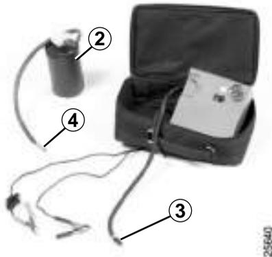
Ist der Reifen korrekt befüllt, können Sie das Set entfernen: Schrauben Sie den Befüllungsaufsatz **3** langsam ab, um zu vermeiden, dass Dichtmittel herausspritzt. Schrauben Sie den Schlauch **4** dann an den freien Anschluss der Flasche **2**, um zu verhindern, dass Dichtmittel ausströmt.
