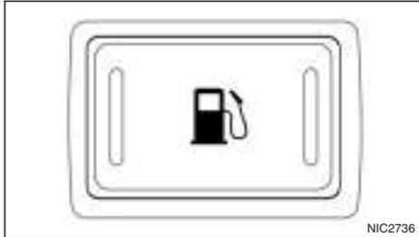
Betätigen Sie zum Öffnen der Tankklappe den Tankklappenentriegelungsschalter an der Unterseite der Instrumententafel.
