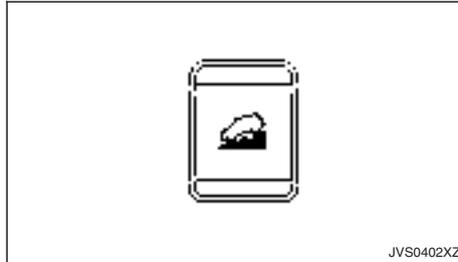
Wenn zusätzliche Bremswirkung an starken Gefällen erforderlich ist, betätigen Sie den Schalter für die Bergabfahrhilfe, um das System zu aktivieren.
