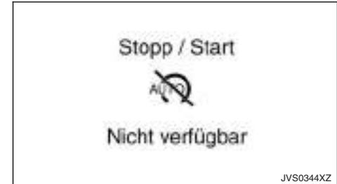
Falls der Motor stoppt, wenn das Stopp-Start-System aktiviert ist, und sich nicht automatisch starten lässt, wird diese Nachricht angezeigt.
