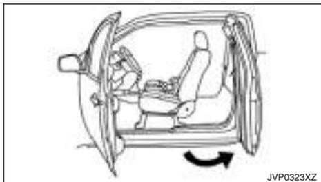
Wenn sich der Hebel in der Stellung LOCK ① befindet, ist die Kindersicherung der Hintertüren aktiviert und die Hintertüren können nur mit den Türaußengriffen geöffnet werden.
