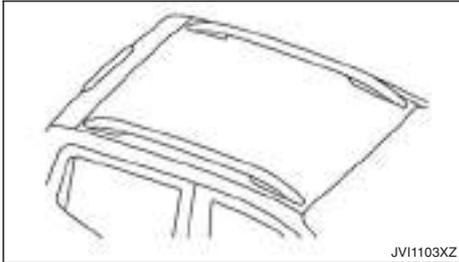
Verteilen Sie das Gepäck immer gleichmäßig auf der Rohrdachreling. Das maximal zulässige Gesamtgewicht beträgt 100 kg (221 lb) (gleichmäßig verteilt).
