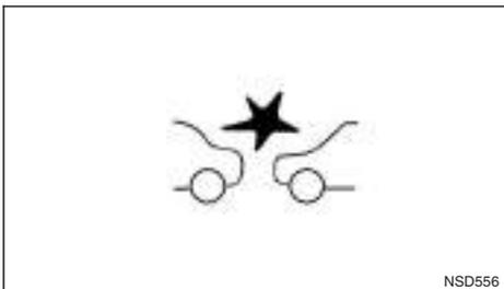
Wenn das aktive Notbremsystem ausgeschaltet wird, leuchtet die Warnleuchte für das aktive Notbremsystem (orange) auf.
