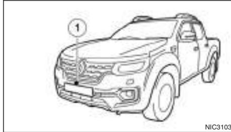
Das aktive Notbremssystem verwendet einen Radarsensor ① vorne am Fahrzeug, um den Abstand zum vorausfahrenden Fahrzeug in der gleichen Fahrspur zu messen.
