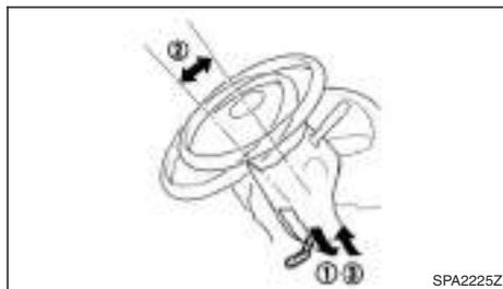
Ziehen Sie den Verriegelungshebel nach unten ① und bringen Sie das Lenkrad in die gewünschte Stellung hinauf/hinab ②.
