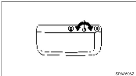
Zur Verriegelung der Heckklappe stecken Sie den Schlüssel in den Schließzylinder der Heckklappe und drehen Sie den Schlüssel im Uhrzeigersinn ①.
