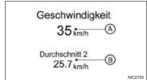
Die (digitale) Geschwindigkeit (A) zeigt die aktuelle Fahrgeschwindigkeit an.
