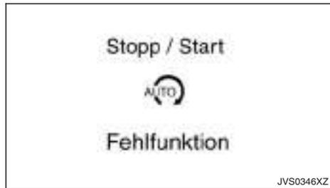
Diese Nachricht wird angezeigt, wenn eine Funktionsstörung im Stopp-Start-System auftritt.
