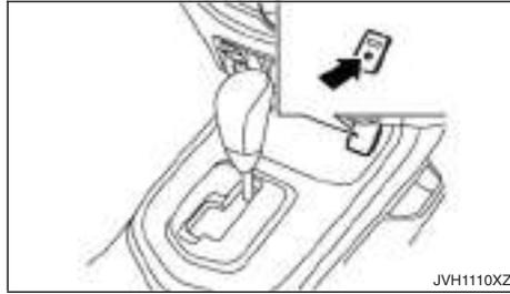
Die AUX-Eingangsbuchse befindet sich an der unteren Seite der Instrumententafel. Kompatible Audiogeräte, hierzu zählen bestimmte MP3-Abspielgeräte, können ebenfalls über die AUX-Eingangsbuchse angeschlossen werden.
