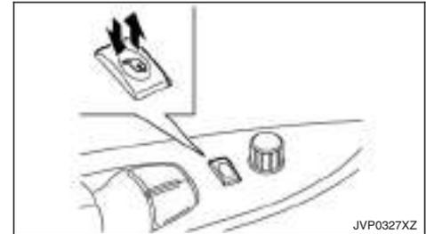
Der Schalter für elektrisch verstellbare Außenspiegel ist funktionsbereit, wenn sich der Zündschalter in der Stellung **ACC** oder **ON** befindet.
