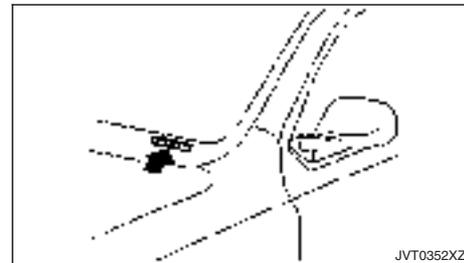
Das Fahrzeugidentifikationsnummernschild ist an der abgebildeten Stelle angebracht. Diese Nummer ist die Identifikationsnummer Ihres Fahrzeugs und wird bei der Fahrzeugzulassung verwendet.
