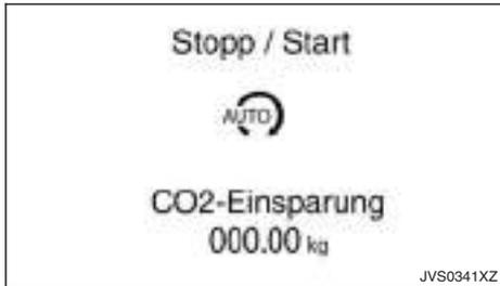
Wenn der Motor abgestellt wird, wird diese Information für einige Sekunden angezeigt.
