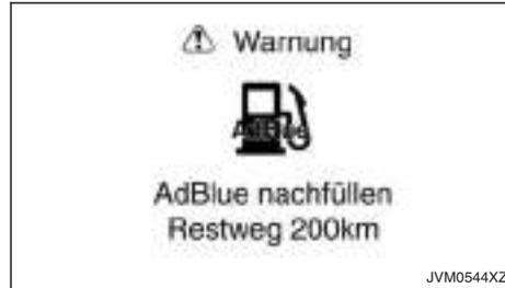
Diese Warnung zeigt die geschätzte Fahrstrecke (0 bis 1000 km (0 bis 621 Meilen)) an, die noch zurückgelegt werden kann, bevor der AdBlue®-Behälter aufgefüllt werden muss.
