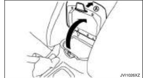
Zum Öffnen des Konsolenfachs drücken Sie den Knopf (A) nach oben und ziehen Sie den Deckel nach oben.
