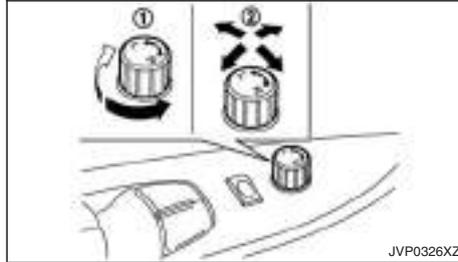
Der Schalter für elektrisch verstellbare Außenspiegel ist funktionsbereit, wenn sich der Zündschalter in der Stellung **ACC** oder **ON** befindet.
