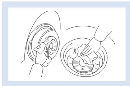
Limpe a superfície de todos os elementos corrosivos com uma escova de aço antes de instalar as rodas. O mau contato entre as faces das superfícies de metal, durante a instalação, fará com que os parafusos fiquem soltos. Isso pode fazer com que a roda caia durante a condução.
