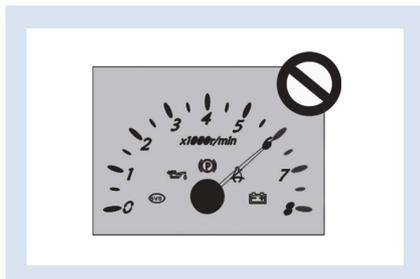
O conta-giros mostra a velocidade de rotação do motor em milhares de rotações por minuto (rpm). Sua função é selecionar o momento certo para fazer a mudança de marcha e evitar o esforço prolongado sobre o motor e a aceleração, o que causaria desgaste excessivo do motor e alto consumo de combustível, respectivamente.
