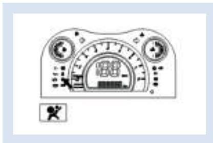
O air bag é monitorado pela Unidade de Controle Eletrônico (Electronic Control Unit). A função de autodiagnóstico, no painel de controle, indica as condições do sistema.
