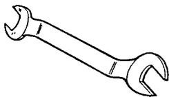
Viscous fan coupling spanner
