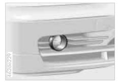
Front fog lamps HB4 bulb, 55 watts
