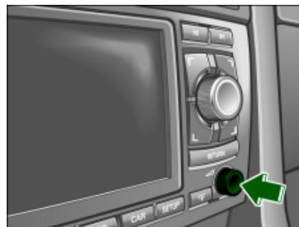
Fig. 3 Navigations-system: ON/OFF knob ►
