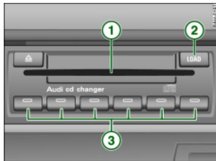
Fig. 42 Audi cd changer: Loading CDs
