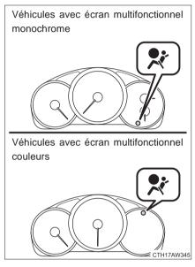
Un système de diagnostic contrôle continuellement fonctionnalité du système d'airbag SRS (y-compris les prétensionneurs des ceintures de sécurité avants) lors de la conduite du véhicule. Le témoin lumineux du système d'airbags SRS montrera l'opération normale en s'allumant pendant environ 6 secondes quand le contacteur de démarrage est mis en position "ON".
