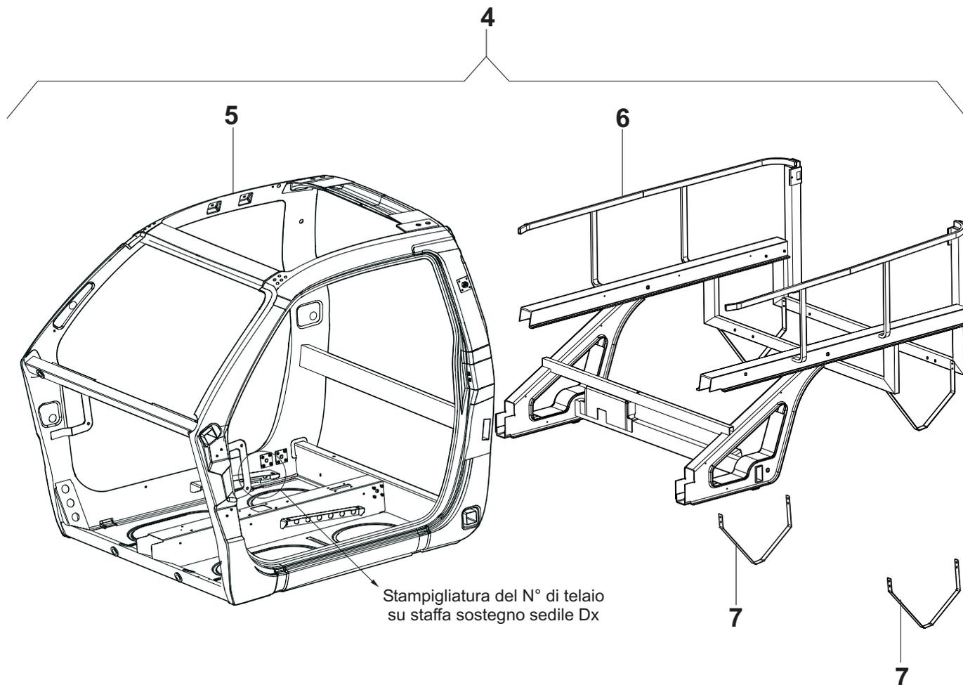
In caso di sostituzione dell'ossatura, rendere il pezzo di alluminio che riporta stampigliato il N° di telaio
