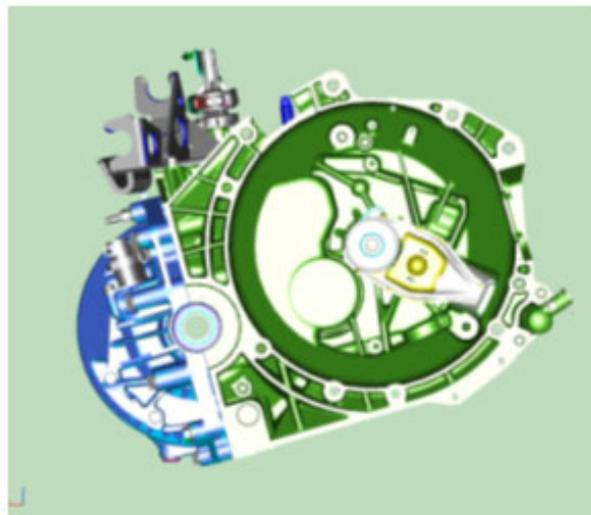
Il cambio utilizzato per la motorizzazione 2.2 100cv è l' MLGU 5marce con comando idraulico frizione a pistone esterno.
