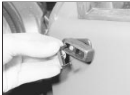
11.7b . . . the door mirror adjuster . . .
