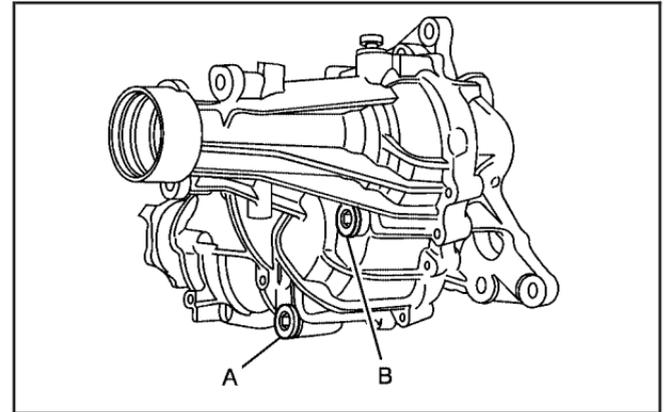
**(A) Drain Plug (B) Filler Plug**
