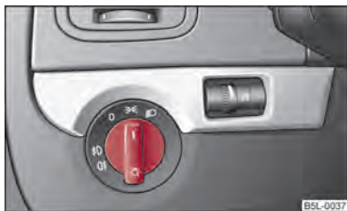
Fig. 24 Dash panel: Light switch
